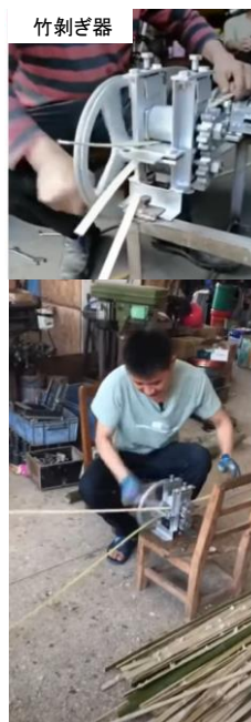
割り材の剥ぎ作業
