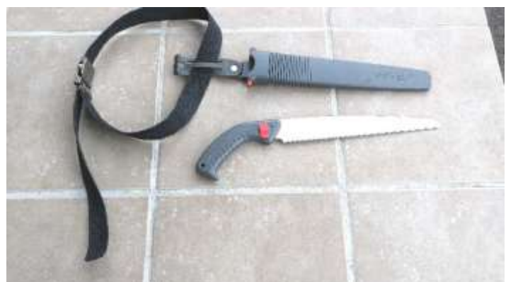
鞘付きの竹用鋸の例 (竹用鋸は、替え刃式が便利)
